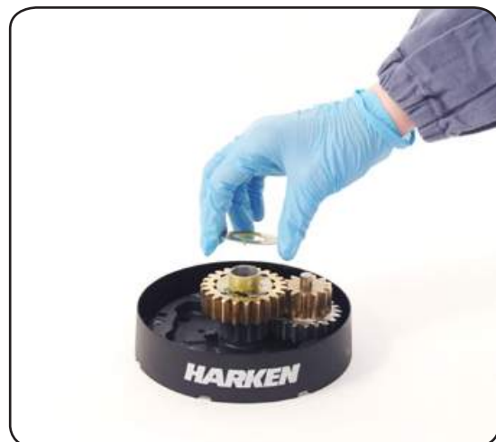
11. Remove the washer n°12
